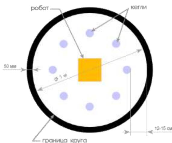
2. **Кегли:** Кегли представляют собой жестяные цилиндры и изготовлены из пустых стандартных жестяных банок (330 мл), используемых для напитков. Диаметр кегли - 70 мм, высота - 120 мм, вес - не более 50 гр, цвет - белый.
